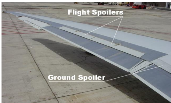
Figure I.13 Les spoilers sur l'aile d'avion et leur influence sur les caractéristiques aérodynamiques
