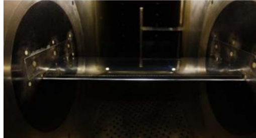
Figure I.16 aile à profil NACA 0012 dans une soufflerie tri-sonique [14]
