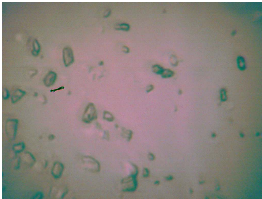
Figure VI.2. Structure microscopique d'une suspension du produit compacté. 1000 x
