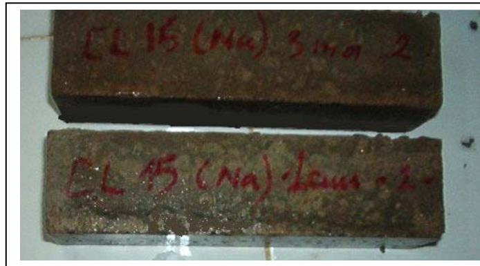
Figure 3.23 : Epreuve de mortier avec 15% d'ajout calcaire après 180 jours d'immersion dans 5% \text{Na}_2\text{SO}_4 .
