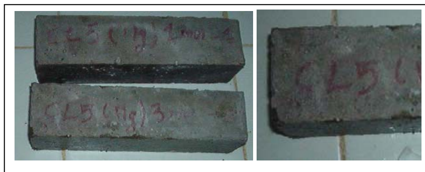
Figure 3.25 : Echantillon de mortier avec 5% d'ajout calcaire après 180 jours d'immersion dans 5% MgSO_4 .
