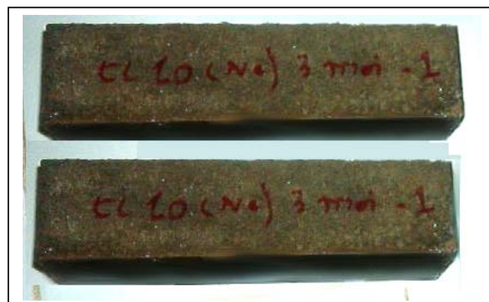
Figure 3.22 : Epreuve de mortier avec 10 d'ajout calcaire après 180 jours d'immersion dans 5% \text{Na}_2\text{SO}_4 .
