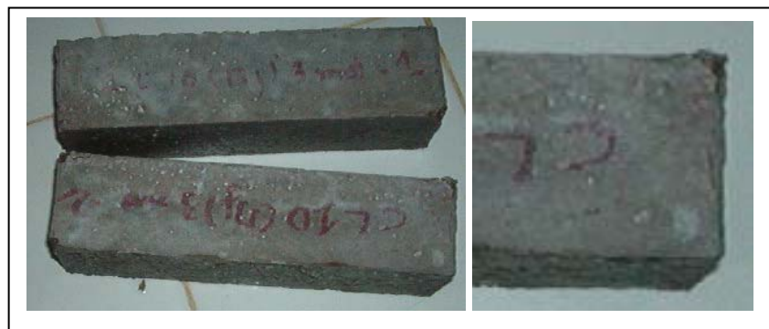
Figure 3.26 : Echantillon de mortier avec 10% d'ajout calcaire après 180 jours d'immersion dans 5% MgSO_4 .
