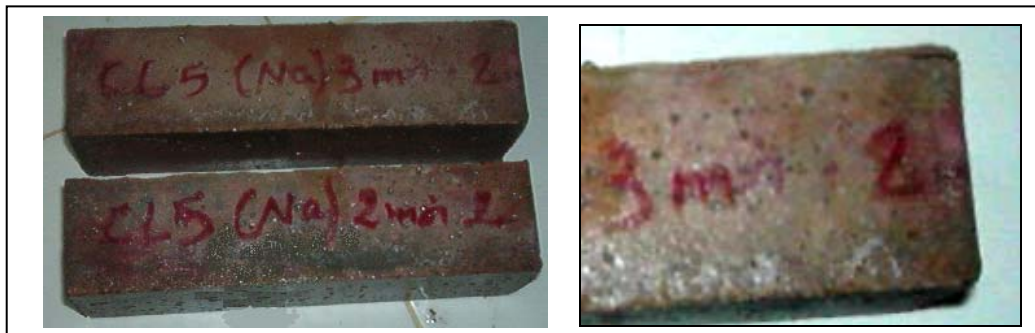
Figure 3.21 : Epreuve de mortier avec 5% ajout calcaire après 180 jours d'immersion dans 5% \text{Na}_2\text{SO}_4 .
