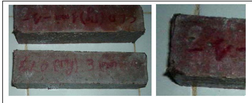
Figure 3.24 : Echantillon de mortier sans ajout calcaire après 180 jours d'immersion dans 5% MgSO_4 .
