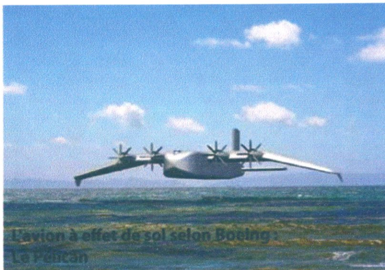
Fig.1.3 L'avion à effet de sol selon Boeing :
