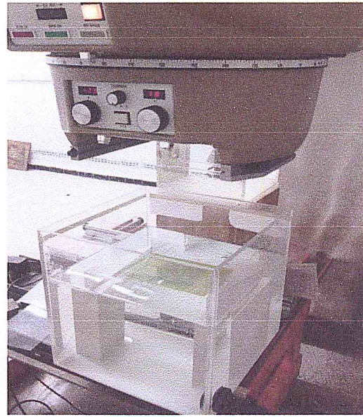
Figure IV. 12. Irradiation du film dans l'eau.
