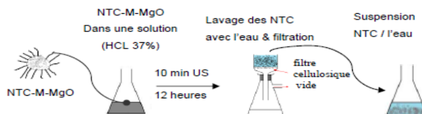
Figure 2.1 : Principe de l'extraction des NTCs par HCl et lavage
