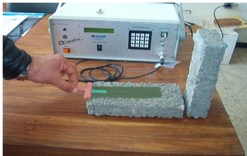
Figure 4.5: L'appareil de mesure de la conductivité thermique (CT-METRE)
