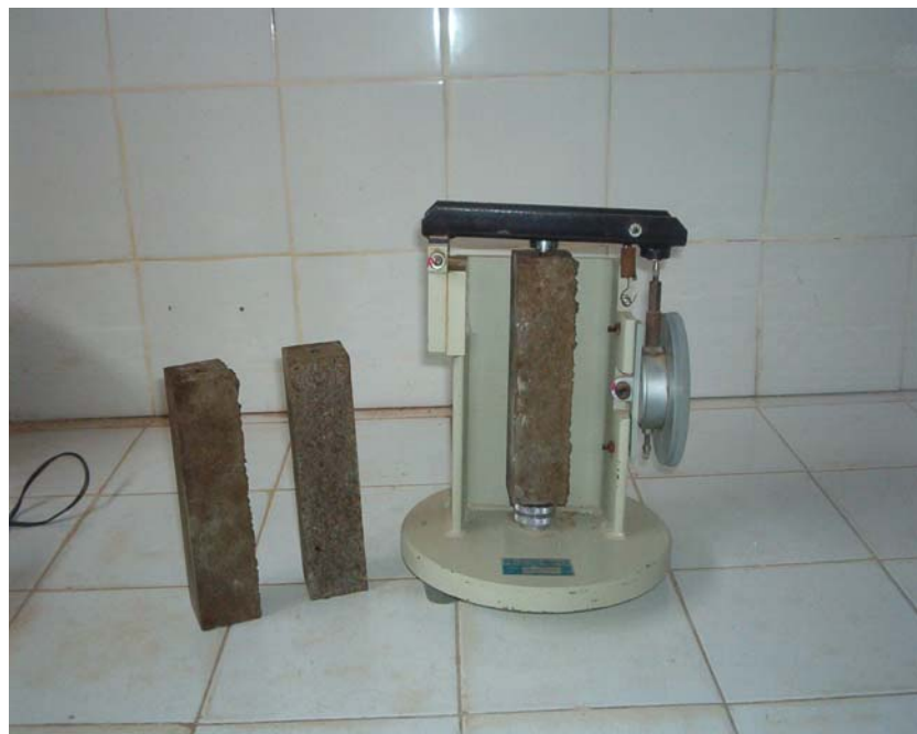
Figure 4. 3 : Appareil utilisé pour la mesure de la variation dimensionnelle (Retrait et gonflement)
