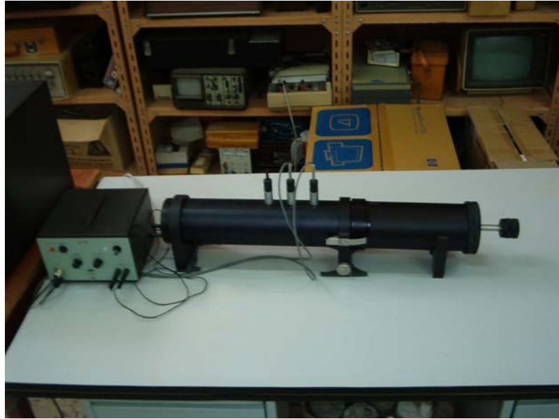
Figure 4.6 : L'appareil de mesure de l'absorption acoustique (double microphone 4206)
