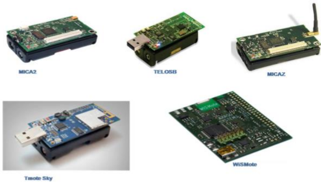
Figure 2.1 : Quelques types de nœud capteur
