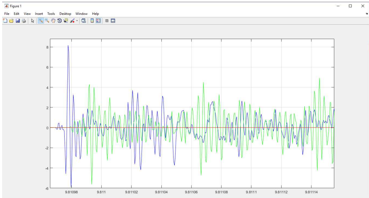
Figure 47. Le signal d'EA acquis par capteur 1 et capteur 2 par rupture de mine
