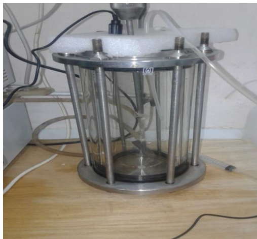
Figure III.3.8: le bio digesteur utilisé vide.
