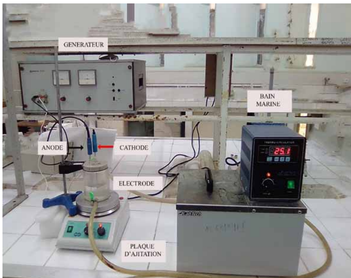
Figure 3.1. Montage expérimental utilisé au cours de l'électro-oxydation du glycérol.
