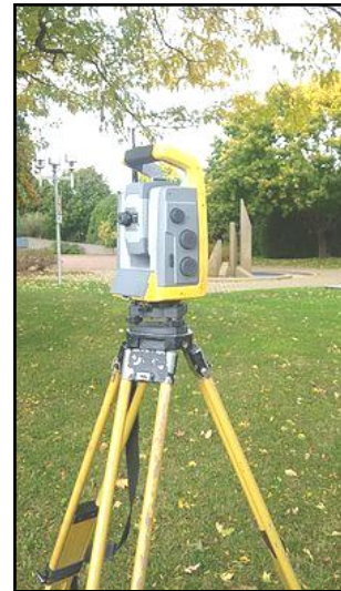
Fig. II.5. Tachéomètre avec trépied Source : Leica
