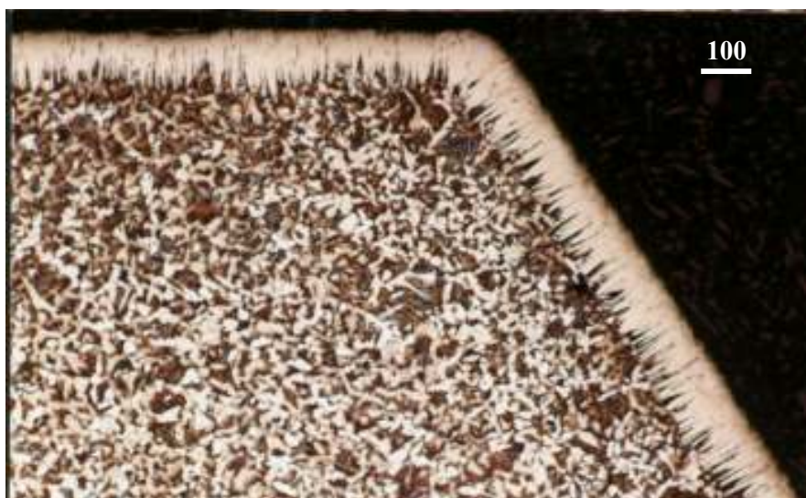
Figure 4.2: Couche borurée obtenue sur l'échantillon XC38 traité dans un bord arrondi (attaque Nital 4 %).
