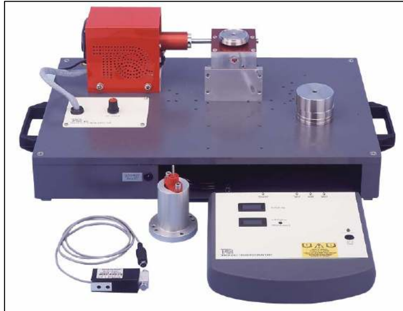
Figure 3.5 : Tribomètre utilisé pour les essais d'usure abrasive « pion-disque ».
