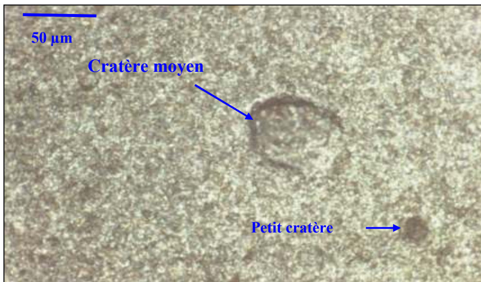
Figure 5.7 : Petits cratères obtenus sur la couche borurée suite à un essai d'érosion par des particules solides ayant un angle d'impact de 90^\circ .
