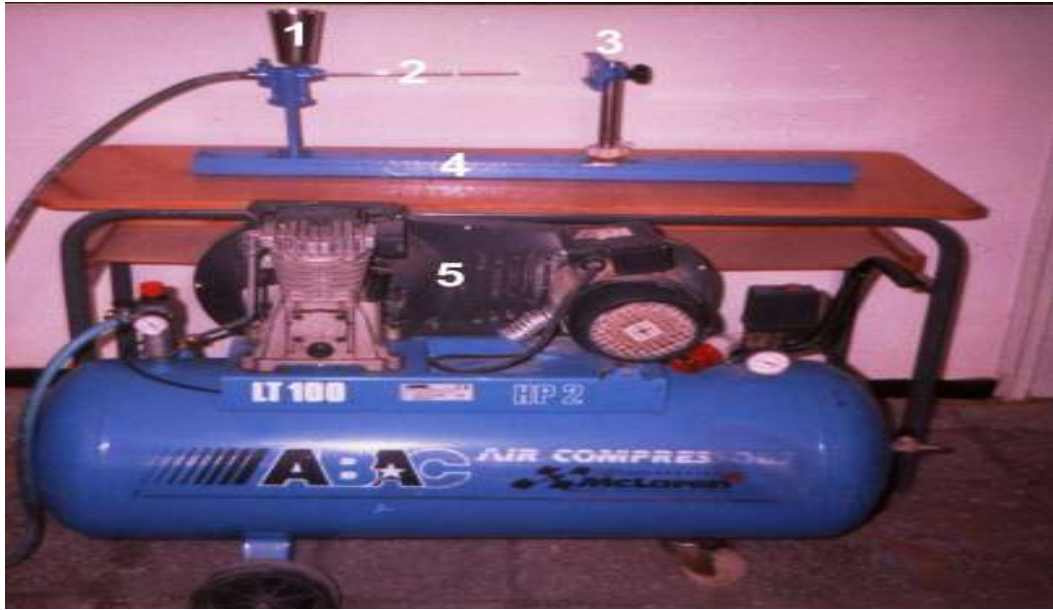
Figure 3.6 : Dispositif utilisé pour les essais d'usure érosive.
