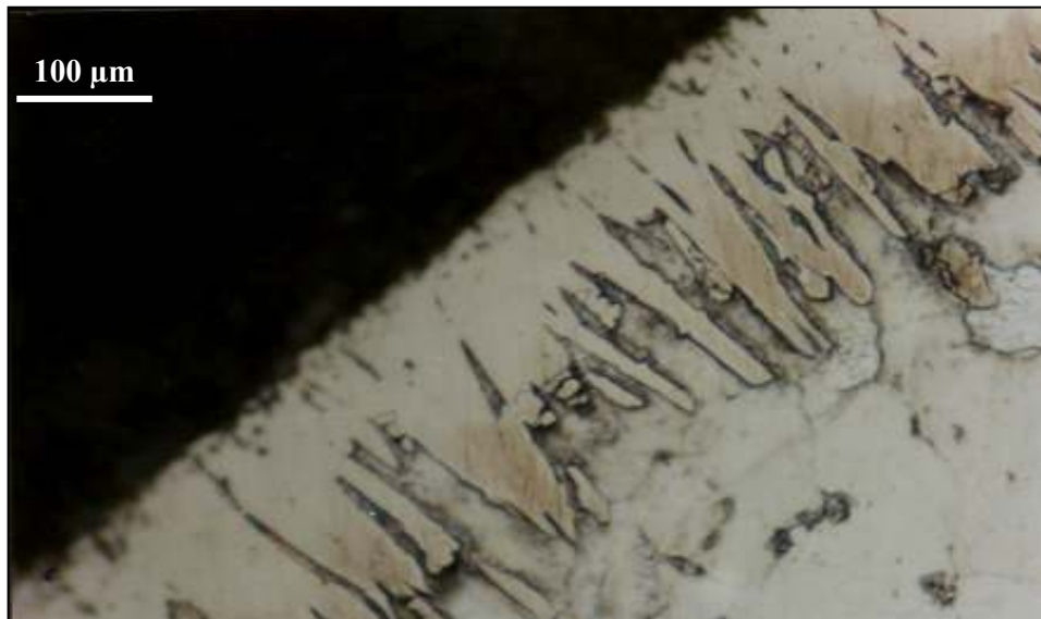
Figure 4.1: Couche borurée obtenue sur l'échantillon traité à partir d'une poudre constituée de 5 % B_4C , 5 % NaBF_4 et 90 % SiC et pour un traitement de 4 heures à 900 °C.
