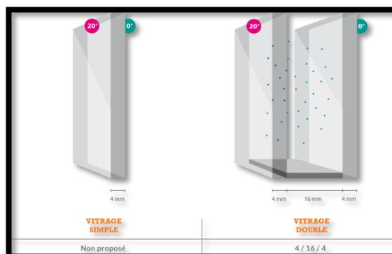
**Figure I-26:** le simple vitrage, Srce (<http://www.seloFrance.fr/vitrage.php>)
