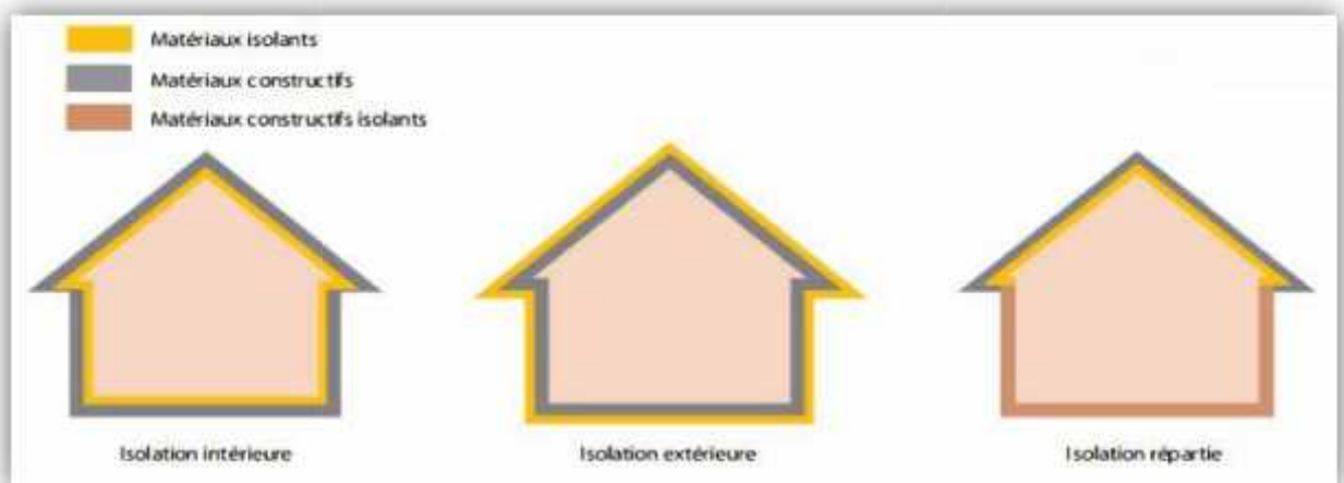
Figure 1-12 : Les procédés d'isolation [37]
