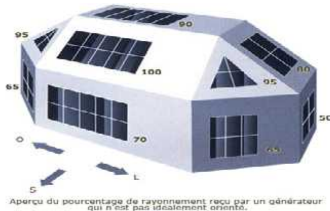
Figure IV.3 Aperçu du pourcentage reçu par un générateur qui n'est pas idéalement orienté
