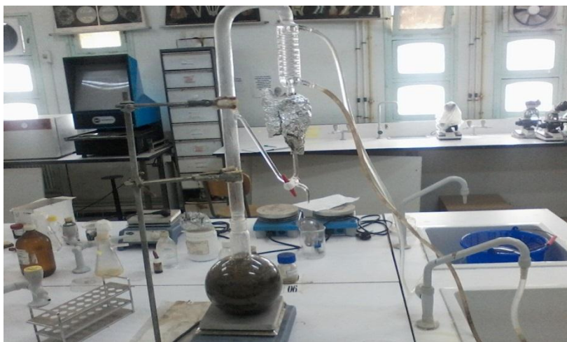
Figure 05 : Montage d'hydro-distillation employé pour l'extraction de l'huile essentielle.
