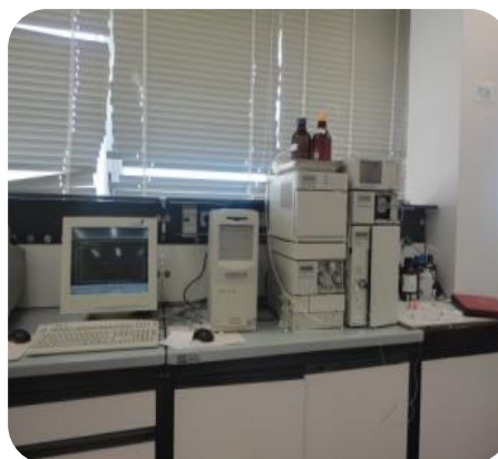
Figure 11. Appareil HPLC (Schimadzu logiciel Class VP version 5.3.)
