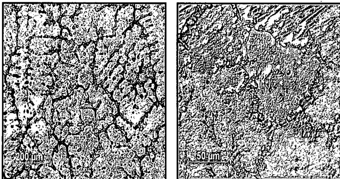
Figure 4.20 : Micrographies optique de l'alliage FeAlTiBZr homogénéisé: a) x20, b) x50 en mode (DIC).
