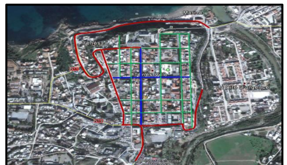
Figure 28 système de voirie de noyau colonial
