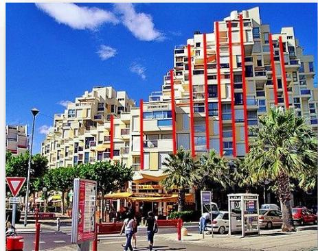
❖ **Pare-soleil verticaux** protègent les murs extérieurs de l'ensoleillement direct permettent une ventilation par convection le long de la paroi extérieure du bâtiment.
