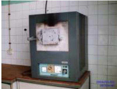
Figure 3. 6 : four de traitements thermiques.
