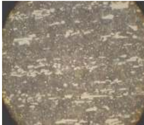
Figure 4. 5 : Micrographie optique de l'acier Z200C12 à l'état brut (x1000)
