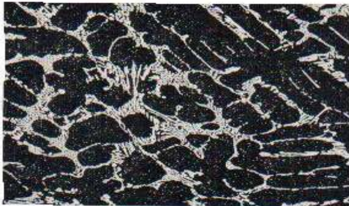
Figure 1. 3 : Structure d'un acier lédeburitique à l'état brute de coulée [6]
