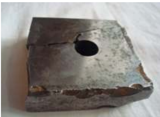
Figure 4. 1 : Rupture et écaillage d'une lame de cisaille, traité à 56 HRC par trempe à 960°C puis revenu à 400°C
