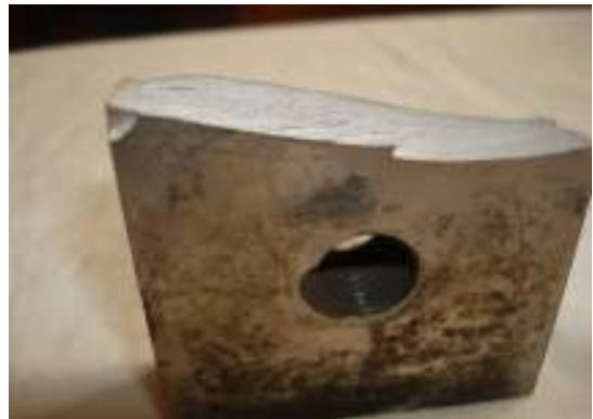
Figure 4. 4 : Rupture totale d'une lame de cisaille, traité à 56 HRC par trempe à 960°C puis revenu à 400°C
