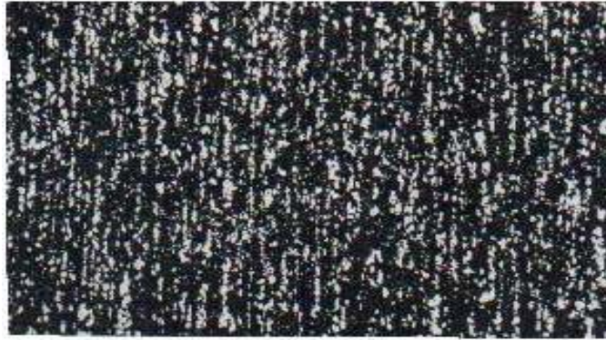
Figure 1. 6 : Micrographie d'un acier lédeburitique Z160CDV12 forgé à partir d'un Lingot [6]
