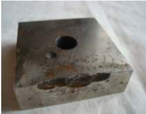
Figure 4. 3 : Ecaillage prématuré d'une lame de cisaille, traité à 56 HRC par trempe à 960°C puis revenu à 400°C
