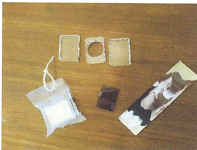
Figure I. 7. Dosimètre de radon à base de détecteur solide de traces nucléaires
