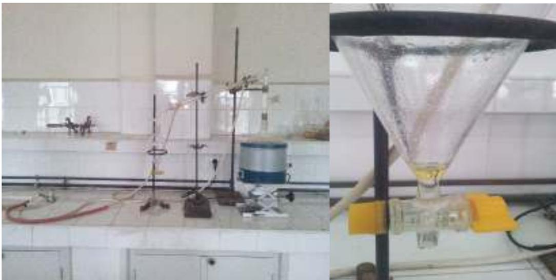
**Photo 5:** Dispositif d'extraction d'HE par l'appareil de Clevenger.
