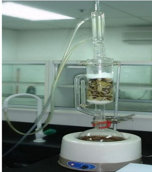
**Figure 6 : Soxhlet extracteur**
