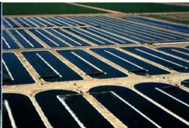
Photo des bassins de production de micro-algues de la société Earthrise situés sur les côtes Californienne
