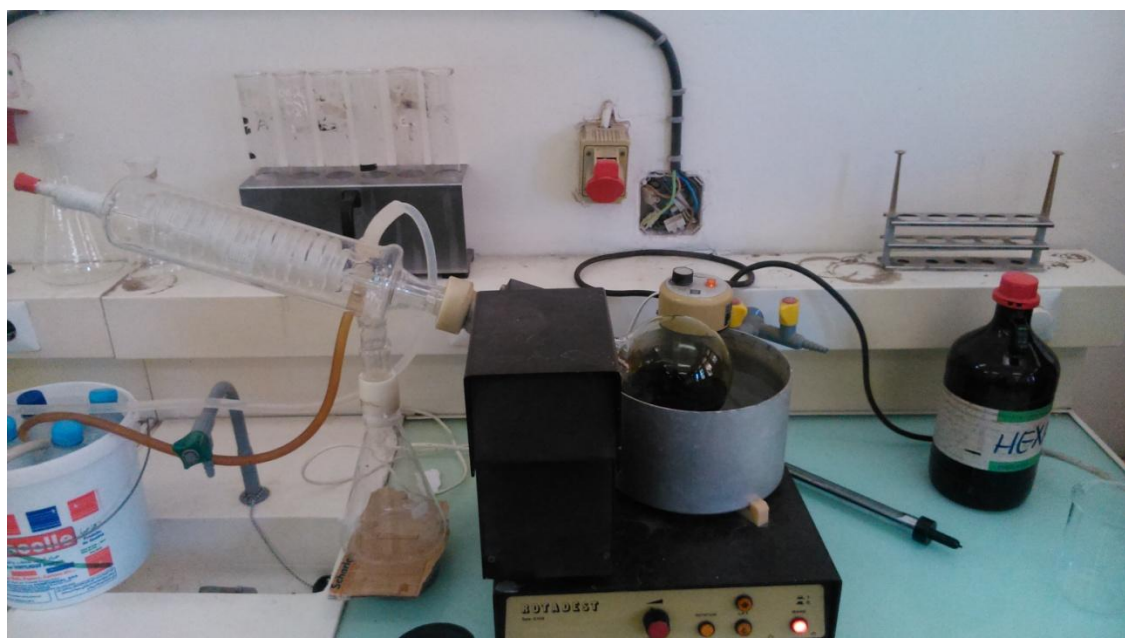
Figure 10: Elimination du solvant par un évaporateur rotatif (Originale 2016.)
