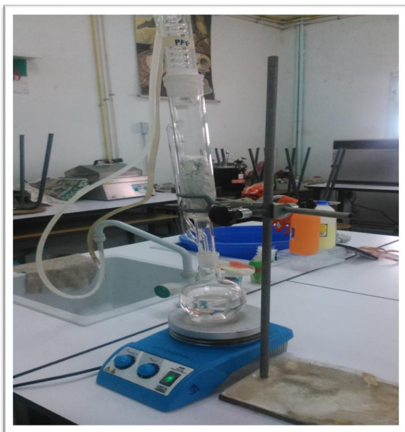
Figure 9 : Extraction par le montage du Soxhlet (Originale 2016)
