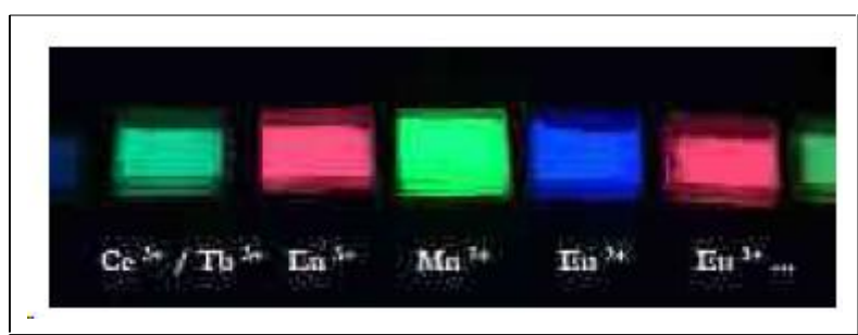
Figure I-7: Quelques exemples de cations métalliques utilisés pour marquer les billets de banque.
