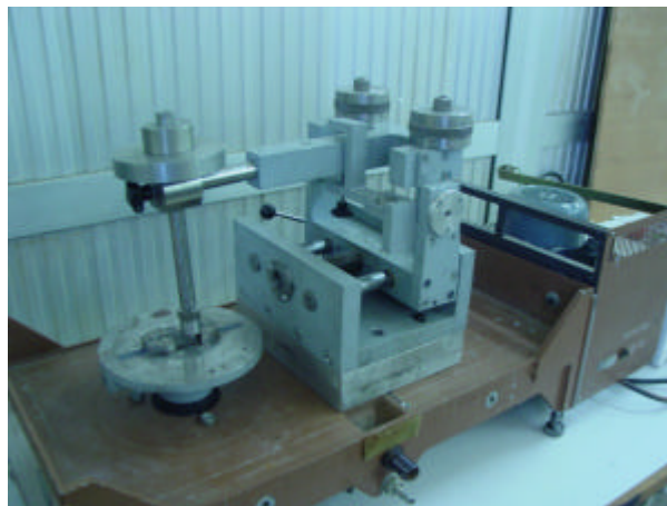
Figure 3.6 : Machine d'usure conçue au LTSM.
