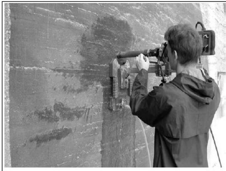
Figure 1.8: Prélèvement par carottage [6].
