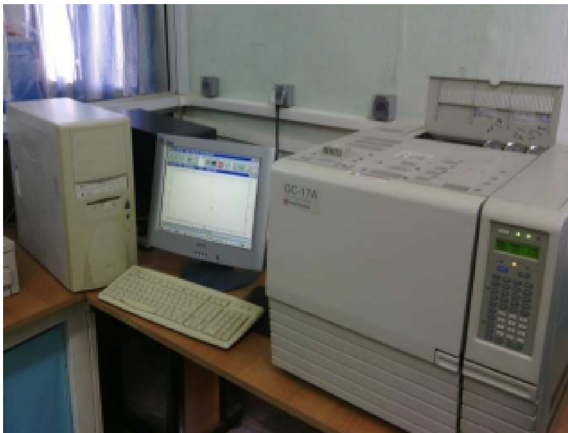
FIGURE 2.2 – CPG utilisée, GC-17 SHIMADZU
