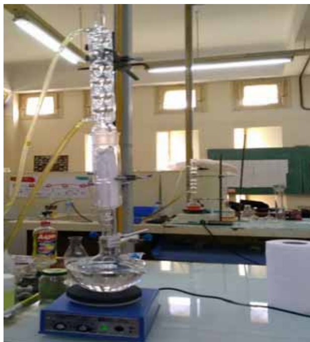
Figure 3.1 : Extraction par soxhlet.
