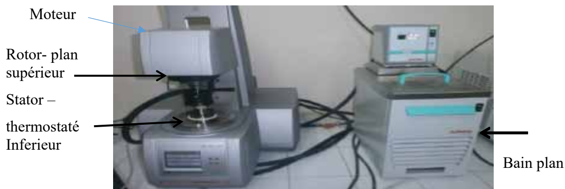
Figure 3.6 : Rhéomètre Anton Paar Modular Compact Rheometer MCR 302.
