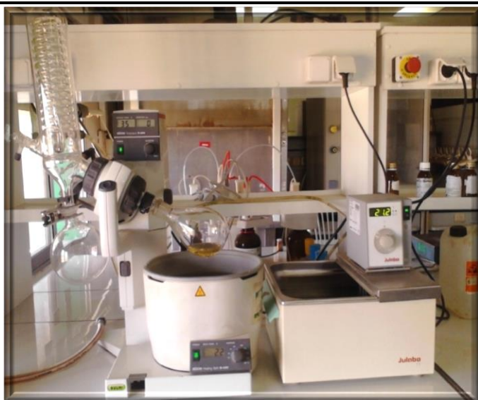
Figure 12 : l'évaporation de l'extrait méthanolique de Stevia rebaudiana avec l'évaporateur rotatif
