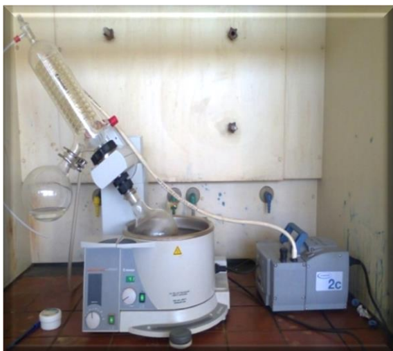
Figure ( 18 ) : Evaporation à sec sous pression réduite de la solution méthanolique de Stevia rebaudiana dans un évaporateur rotatif.
