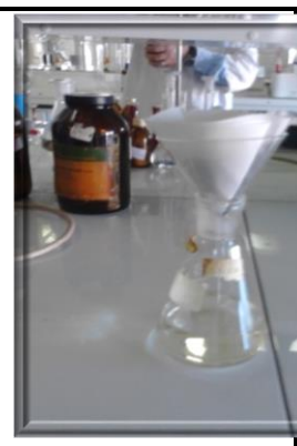
Figure (15) : Etapes de purification de l'extrait brut méthanolique de Stevia rebaudiana avec le charbon actif
