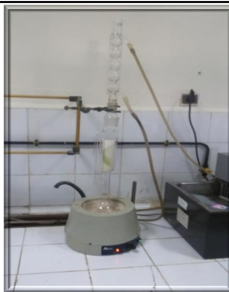
Figure 13: Dispositif du soxhlet
