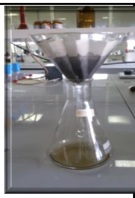
Figure (15) : Etapes de purification de l'extrait brut méthanolique de Stevia rebaudiana avec le charbon actif
