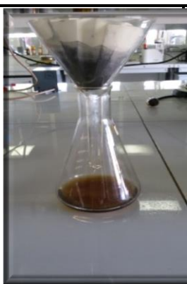
Figure (15) : Etapes de purification de l'extrait brut méthanolique de Stevia rebaudiana avec le charbon actif
