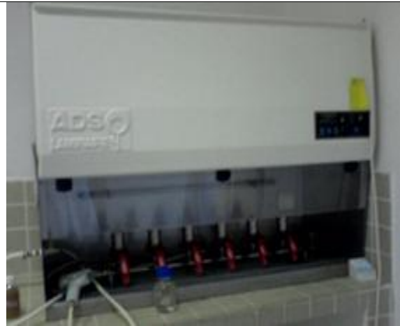
Rampe de filtration
