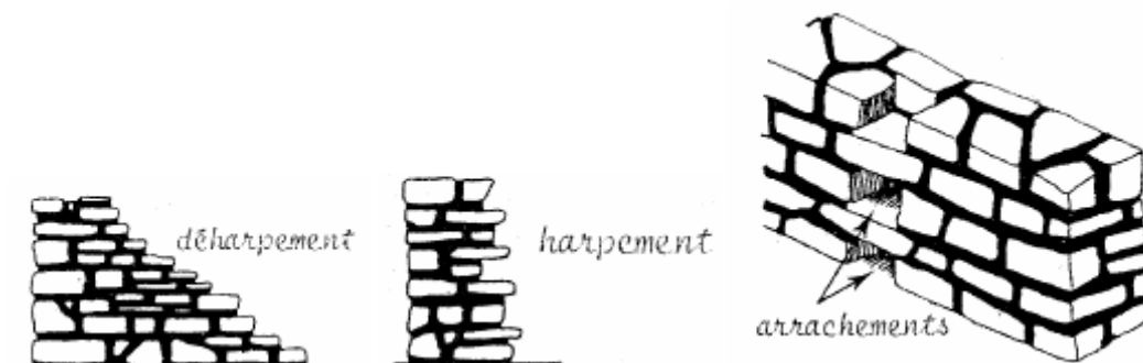
Figure 1: Techniques utilisées pour la jonction de deux murs de maçonnerie de moellons [2]
