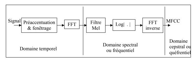
Figure 2.9 : Algorithme de calcul des MFCCs
