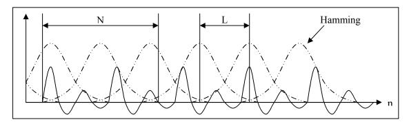
Figure 2.7 : Découpage d'une séquence en tranches avec recouvrement
