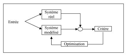
Figure 1.3 : Exemple d'un système d'apprentissage
