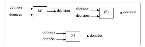
Figure 3.8: Trois architectures pour la fusion de capteurs en traitement de l'information [42].
