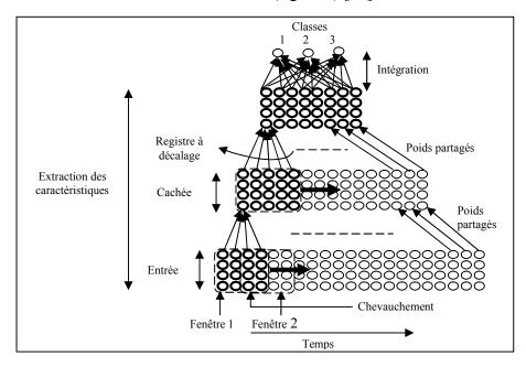
Figure 1.12 : Réseau de neurones à délai TDNN
