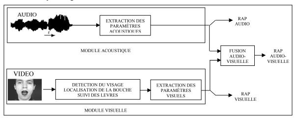
Figure 3.7 : Schéma général d'un système audiovisuel de RAP
