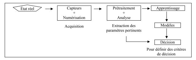
Figure 1.2 : Schéma général d'un système de RDF [9]
