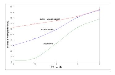
Figure 3.2 : Tests d'intelligibilité réalisés avec différents rapports S/B
