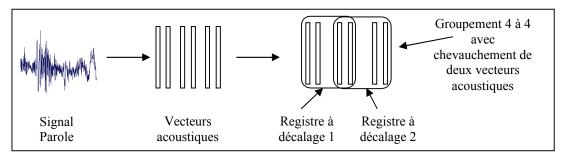
Figure 4.3 : Chaîne de traitements acoustiques
