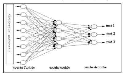
Figure 1.10 : Structure d'un MLP à trois couches
