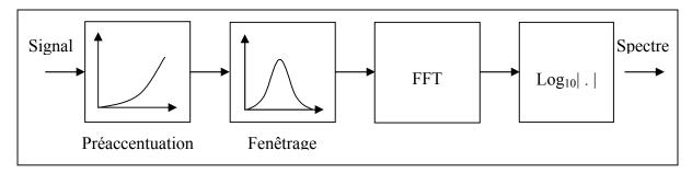
Figure 2.8 : Processus de calcul de spectre d'un signal de la parole
