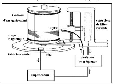
Figure 2.5 : Spectrographe analogique
