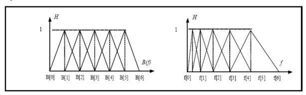
Figure 4.2 : Les filtres triangulaires passe-bande en Mel-Fréq *B(f)* et en fréquence *(f)*
