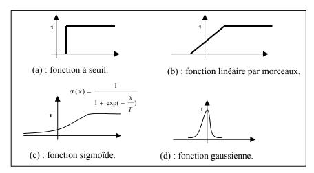
Figure 1.8: Quelques fonctions d'activation [54]
