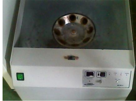
**Fig.11 : Centrifugeuse GERBER à
