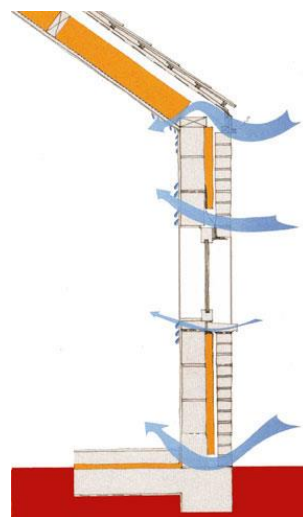
Figure 1.9 : Zones à ponts thermiques.[20]
