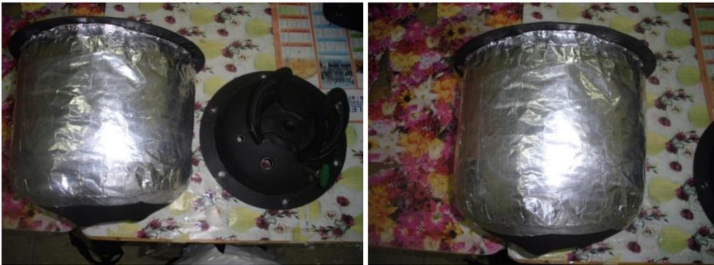
**Figure II.8:** La cuve isolée.
