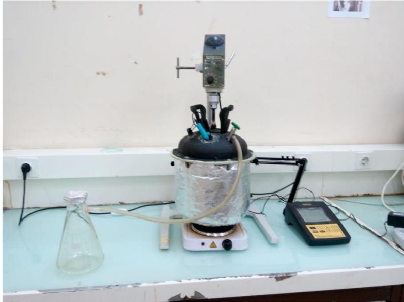
**Figure II.13:** L'installation complète de digesteur.
