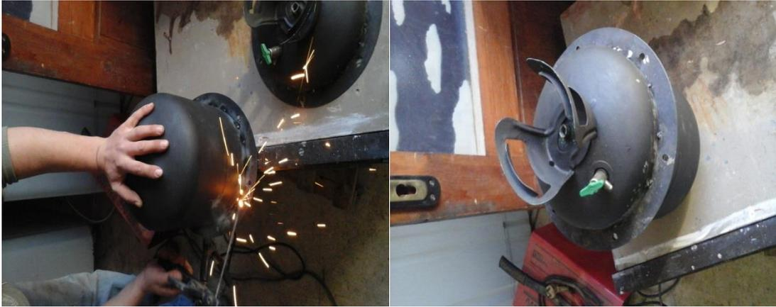
**Figure II.5:**Photo pendant le soudage de joint.
