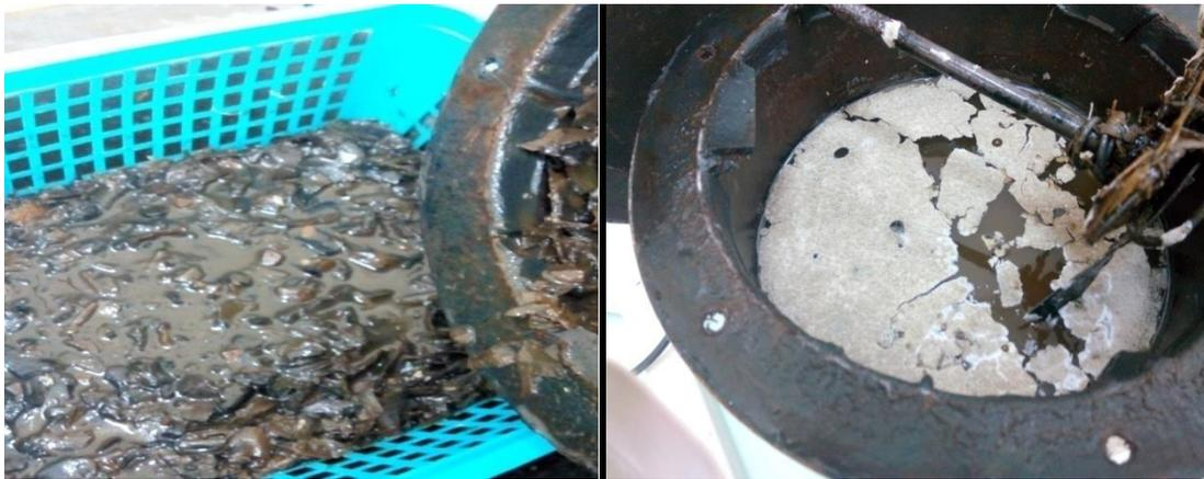
**Figure II.20:** Le substrat après la fermentation .
