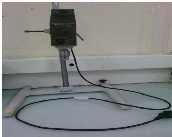
**Figure II.10:** L'agitateur mécanique.
