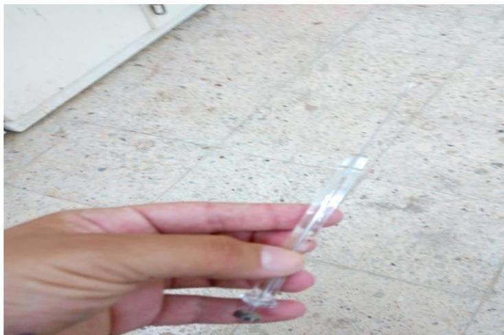
**Figure II.26 :** La seringue utilisé pour récupérer le biogaz .
