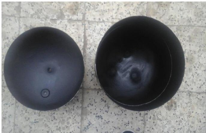
**Figure II.4 :** La cuve teinter à l'intérieure
