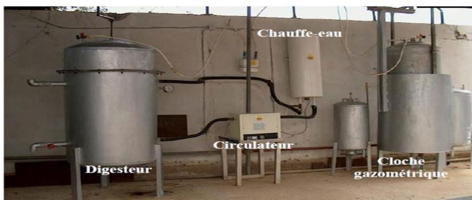
**Figure I.15 :** Le digesteur réalisé par [S.Igoud ,al 2002].
