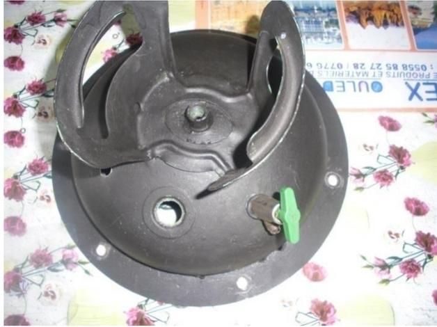
**Figure II.7:** Les trois trous muni a la cuve.
