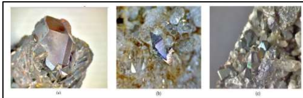
Figure1.5 : TiO 2 Rutile (a), anatase (b) et brookite (c). [20].
