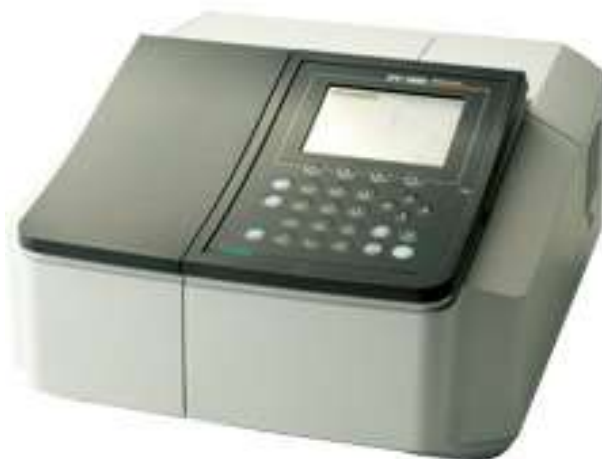
Figure 3.4 : Spectrophotomètre UV-Visible de marque SHIMADZU, type 1800 [77].
