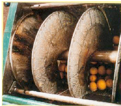
Figure I.4 :Montage de l'expression à froid [23]
