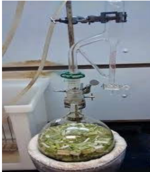
Figure I.2 : Procédé d'extraction d'une huile essentielle par entraînement à la vapeur d'eau.
