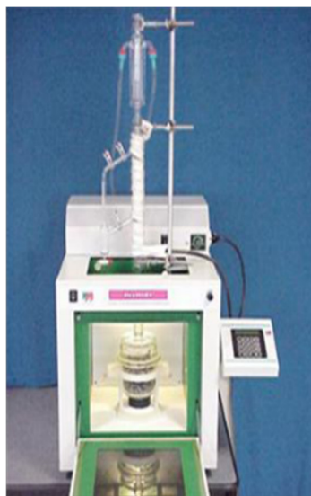
Figure I.8 : montage d'extraction assistée par micro-onde
