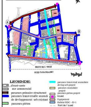
le schéma montre le principe de la projection des voiries (voies mécanique voies piéton) qui renforcent la relation entre les axes structurant de centre ville de Tamanrasset.
