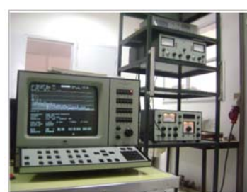
Photo 3 : Analyseur de signaux 2032, générateur de signaux et amplificateur de puissance
