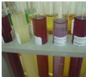
La recherche des coliformes et streptoques dans l'eau
