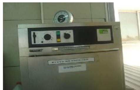
Etuve de séchage(memmert T430(30C°-250C°))
