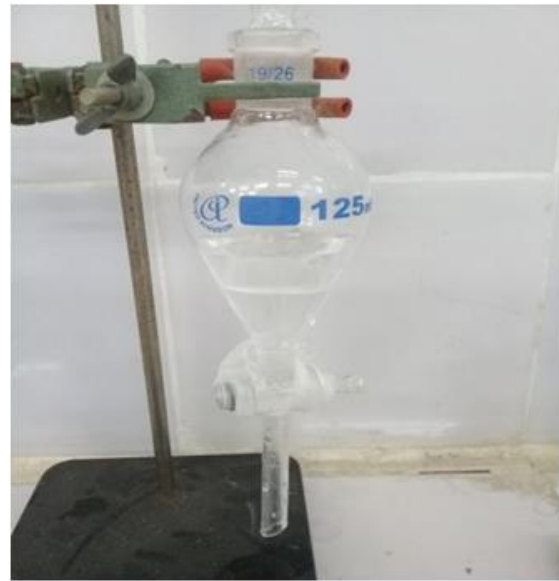
Figure 20 : Après l'équilibre et la séparation des deux phases
