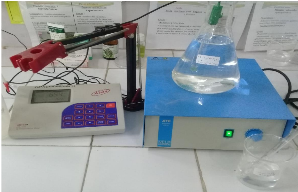
Figure 21 : Préparation d'un tampon ph6.5
