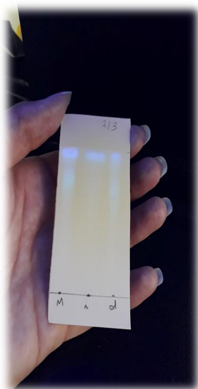
Révélation sous UV à 366 nm (Systeme7/3)
