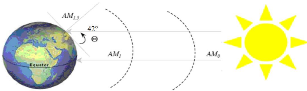
Figure I.1 : Description de nombre d'air –masse ; AM_0 (spectre solaire en dehors de l'atmosphère), AM_1 (spectre solaire au sol lorsque le soleil est situé au zénith) et AM_{1.5} (spectre solaire au sol pour un rayonnement solaire ayant un angle d'incidence de 48,2°).
