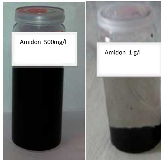
Figure 4.13 : dispersion des nanotubes de carbones par amidon soluble.
