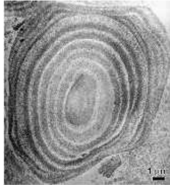
Figure 1.5 : Image MET d'une coupe ultrafine d'un grain d'amidon de maïs cireux partiellement hydrolysé à l'acide chlorhydrique (inclusion dans une résine, colorée par une solution aqueuse d'acétate d'uranyle et de citrate de plomb).
