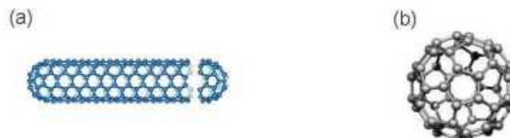
Figure.2.2 : Représentations (a) d'un NTC monoparoi fermé par deux demi-fullerènes ; (b) du fullerène C60.
