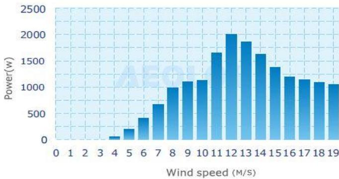
Figure 4.5 Courbe de puissance de l'éolienne de 1kw
