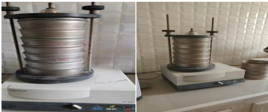
**Figure 19 : Tamiseur de type (Retsch AS 200).**
