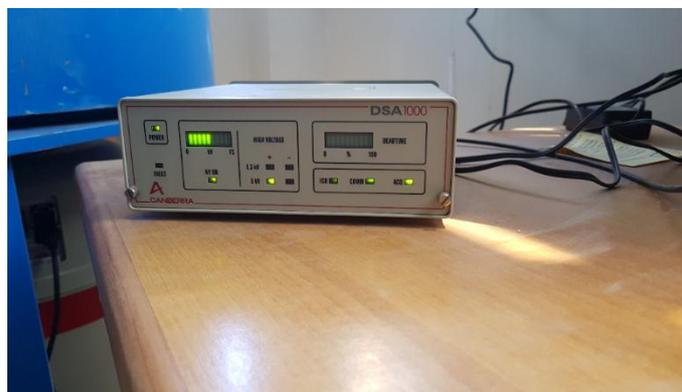
Figure 23 : Rack d'instrumentation de la chaîne de la spectrométrie  $\gamma$ .
