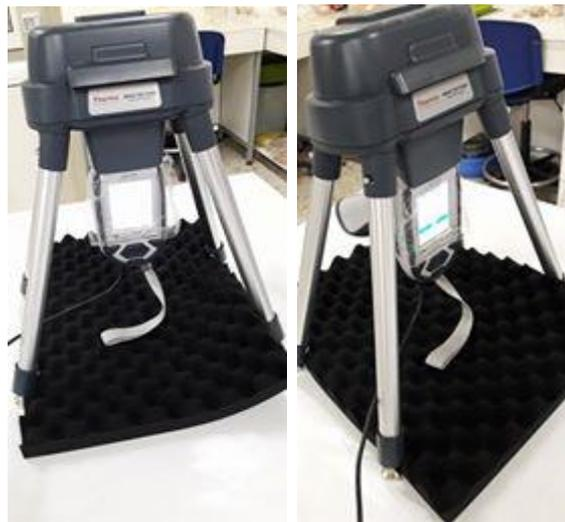
**Figure 24 : Le dispositif de la spectrométrie de fluorescence X.**
