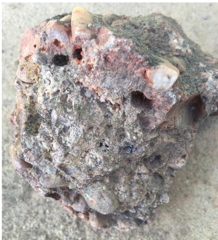
**Figure 14:** échantillon de roche Conglomérat du minerai du Hoggar.
