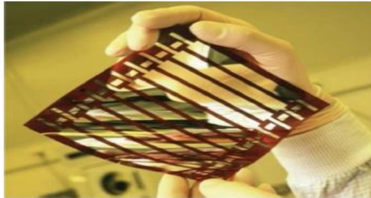
Figure I.10 : Cellule solaire tout organique sur substrat souple [25].
